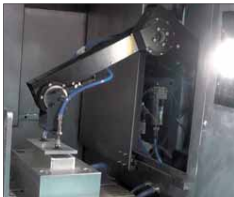
robolink® RL-DC在铣床上的应用 Milling machine with robolink® RL-DC
