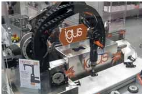
售货系统应用 - 5 DOF 机械臂RL-D 和 RL-S 关节。 经过 igus® 工厂真实环境下的模拟。 Trade fair machine - 5 DOF robot arm with RL-D and RL-S joints. System simulates real use in the igus® factory
